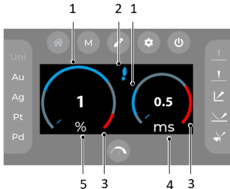
Fig. 6.3 Énergie de soudage et durée d'impulsion
