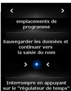
En appuyant sur le régulateur du temps de soudage (25)\*, le menu de programmation est appelé. Lors de la première étape, sélectionnez l'emplacement du programme dans lequel vous désirez sauvegarder vos propres réglages à l'aide de la flèche. Enregistrez ensuite vos propres données en actionnant le bouton de commande avec le point bleu. En appuyant sur le régulateur de temps de soudage (25), vous pouvez interrompre le processus à tout moment, sans que les données ne soient enregistrées.
