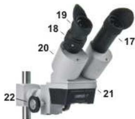
Montez la pièce à main de soudage avec une électrode fixée dans le bras-support. Tournez le bouton de mise au point (22) sur une zone de mise au point moyenne. Ajustez la hauteur de montage du bouton du microscope : tenez le bouton du microscope (21) d'une main, sans
